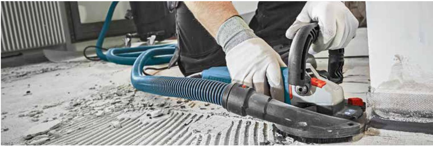
**5" CONCRETE SURFACING GRINDER**
